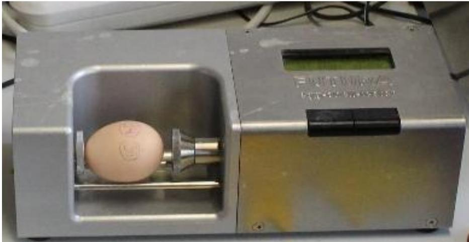
Abbildung 32 Bruchfestigkeits-Messgerät zur Bestimmung der Schalenstabilität
